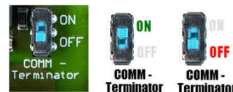
Przełącznik terminatora na płycie PCB Symbol aktywny / nieaktywny
